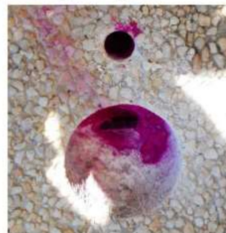
Figuur 3.6. Paarse verkleuring na besprenkeling met fenolftaleïne op meetlocatie I2.2
